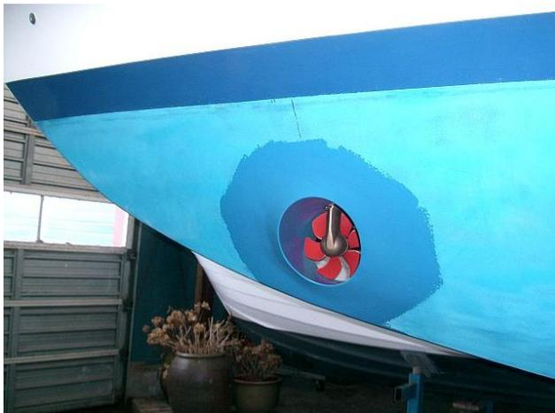
Bekanntlich sollte ein Bugstrahlruder so weit wie möglich nach vorne wegen des Hebelarms und so tief wie möglich angebracht werden, damit keine Luft angesaugt wird. Nach diesen Kriterien legte ich den Einbauort fest.
